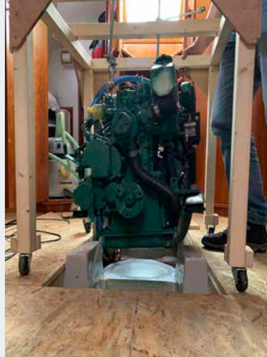
De mobiele bok handig bij tillen en verplaatsen motor
