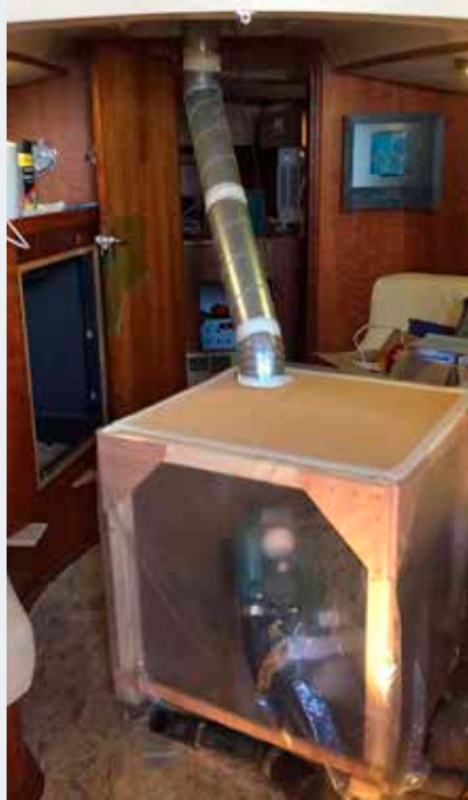
Motorblok krijgt nieuwe verlaag in spuitcabine
