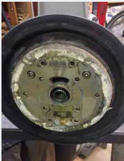
De oude manchete ziet er nog goed uit, maar de plaat ziet er niet zo tof uit
